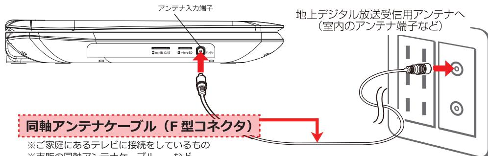
**！ 注意** 本製品に付属されている簡易アンテナと接続しての初期設定の操作も可能ですが、屋外アンテナや共同アンテナと比べると、受信力が低い為、チャンネル登録が難しい場合があります。特にご購入後直後の最初の初期設定を行う際は、上図を参考に受信力の高いアンテナと接続してください。（電波の受信が弱い・安定していないなどの状態で設定を行っても登録できない場合があります）
